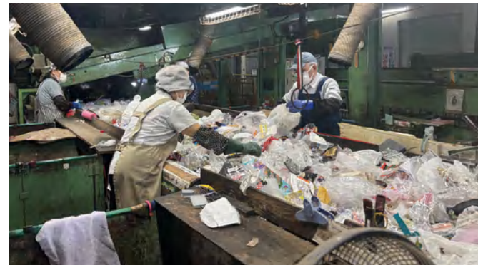
集められたプラスチック類から不適物を取りのぞく様子
