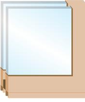
アルミサッシをプラスチックなど熱伝導率の低い素材に変えます。
