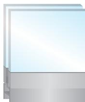
単板ガラスのサッシにアタッチメントを付け、複層ガラスにします。
