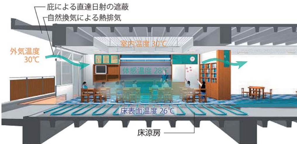
8 自然換気と床下に埋設した冷水管パイプで冷房効果を高める
