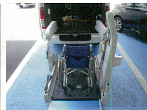
④車いすリフト（後方）
